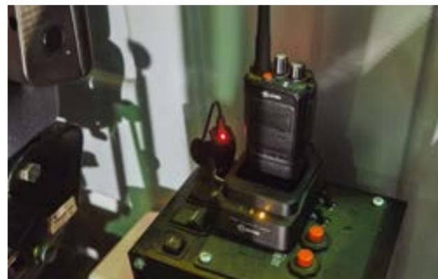
Комплект цифровой радиостанции с программатором и встроенным регистратором переговоров.
