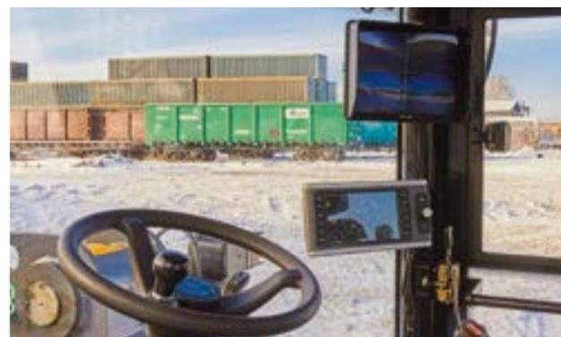
Многоканальный видеорегистратор обеспечивает круговой обзор рабочей зоны, обеспечивая безопасность и контроль площадки.
